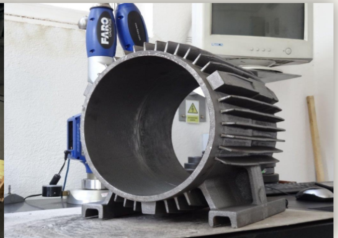
carcasă motor electric 35 kg, material: EN-GJL-250
